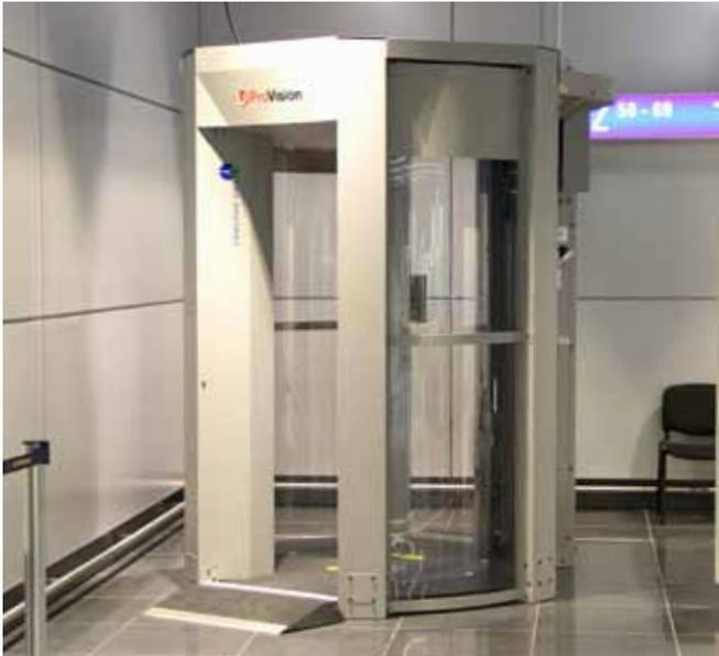
Einer von drei Körperscannern vom Typ L3 Pro Vision, die am Frankfurter Flughafen im USA-Flugverkehr eingesetzt werden
