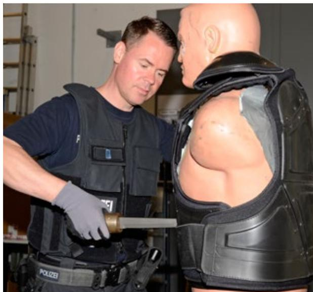
*Praktische Erprobung der Widerstandsfähigkeit bei stumpfer Gewalt ... sowie bei Einwirkung durch ein Messer.*
