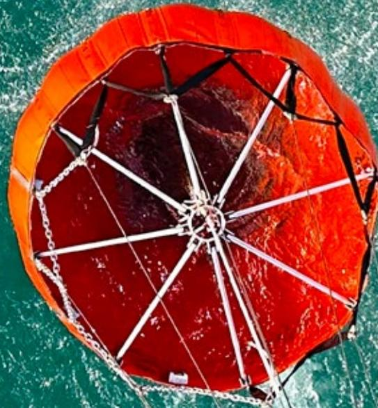
Löschwasseraufnahme mit einem sogenannten Bambi Bucket
