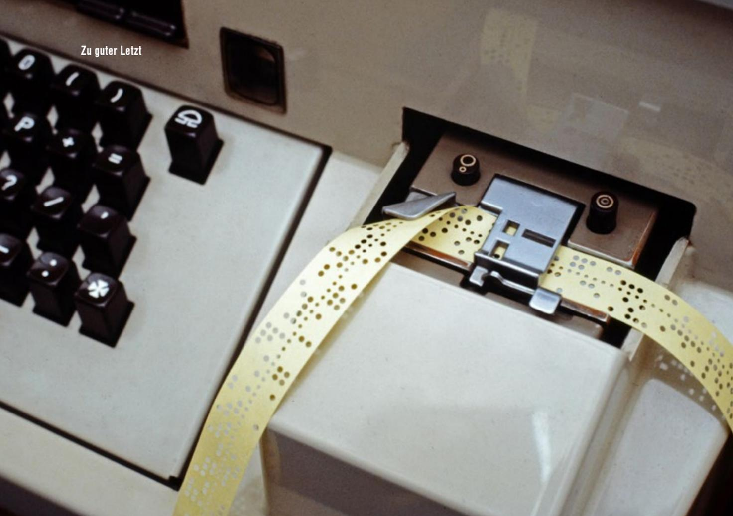
Lochstreifen waren ein robustes Speichermedium und konnten rasch ausgelesen werden – eine Zeile entsprach einem Tastenanschlag.
