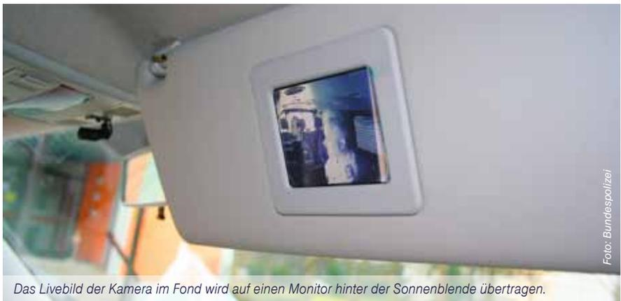
Das Livebild der Kamera im Fond wird auf einen Monitor hinter der Sonnenblende übertragen.
