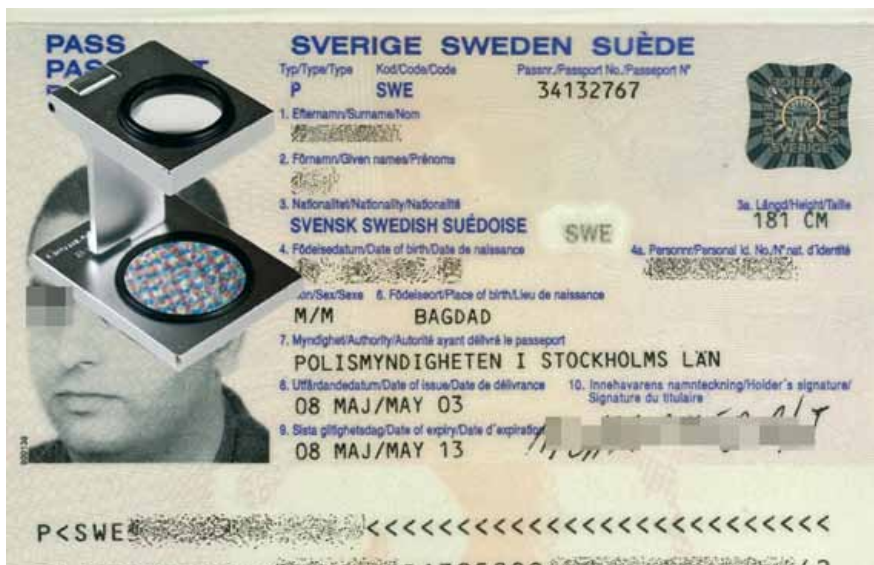
Abbildung 3: falsche Personalisierung beim schwedischen RP. Die farbigen Rasterpunkte in der Faltlupe sind bei einer original Lasergravur nicht sichtbar (siehe Abb. 4).
