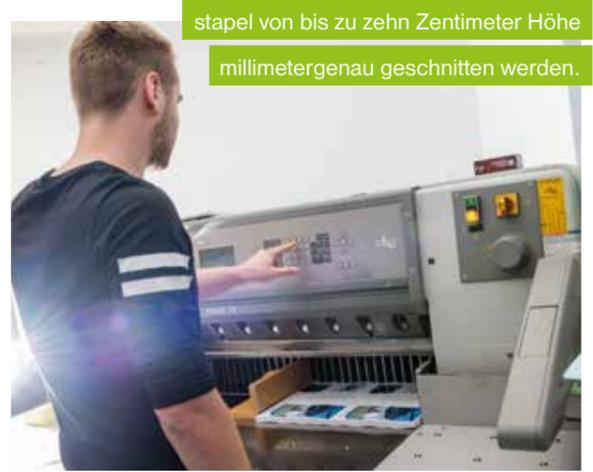
An der Schneidemaschine können Papierstapel von bis zu zehn Zentimeter Höhe millimetergenau geschnitten werden.
