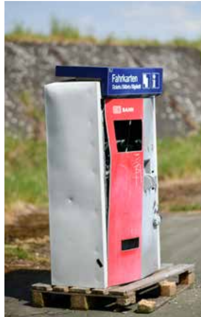
Ergebnis der Simulation einer Fahrausweisautomatensprengung
