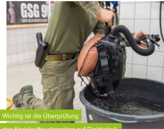
Wichtig ist die Überprüfung des Kreislauf-Tauchgerätes auf Dichtigkeit.
