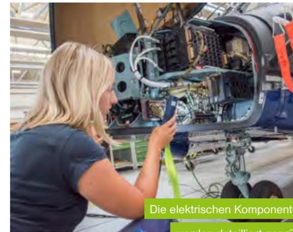
Die elektrischen Komponenten werden detailliert geprüft.
