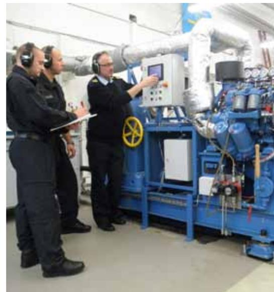
*Fortbildung am Motorenprüfstand/Simulator.*
