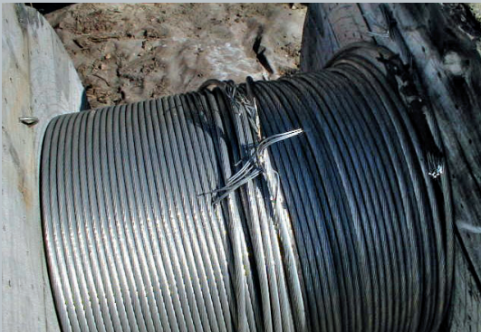
Fahrseil auf Kabeltrommel (Aluminium) 240 qmm, Durchmesser 20,3 mm
